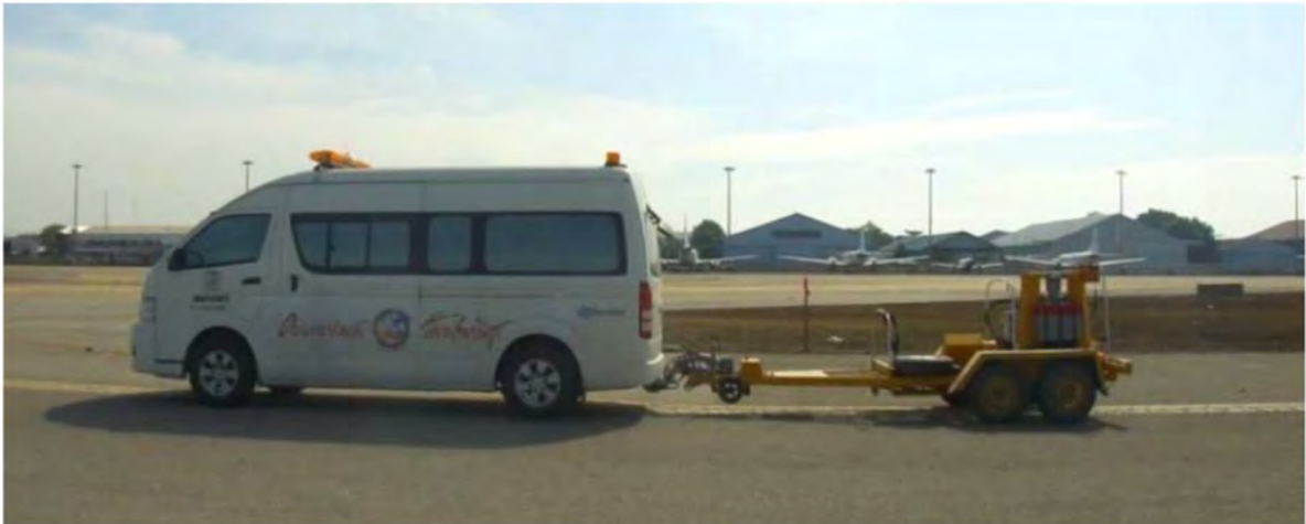
ภาพที่ 2.6 ภาพแสดงอุปกรณ์ Falling Weight Deflectometer
